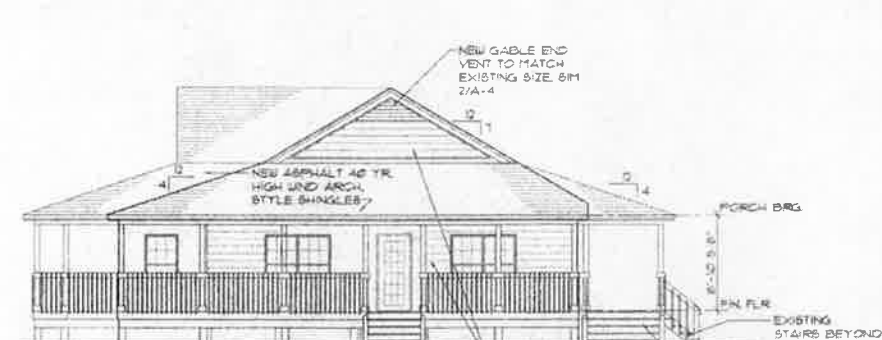
1 EAST ELEVATION A-3 SCALE: 1/8" = 1'-0"
